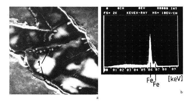
Abb. 25 Schmelzschlacken im Schwert aus Augst (Inventarnr. 1961.1568):
