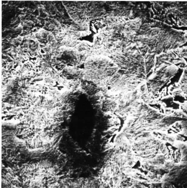
Abb. 15 Schmelzschlacke im Kern des Schwertes aus Augst (Inventarnr. 1961.4401):
