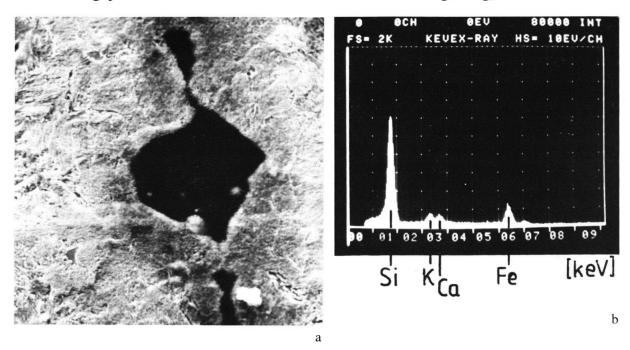
Abb. 14 Schmelzschlacke im Kern des Schwertes aus Augst (Inventarnr. 1961.4401):
