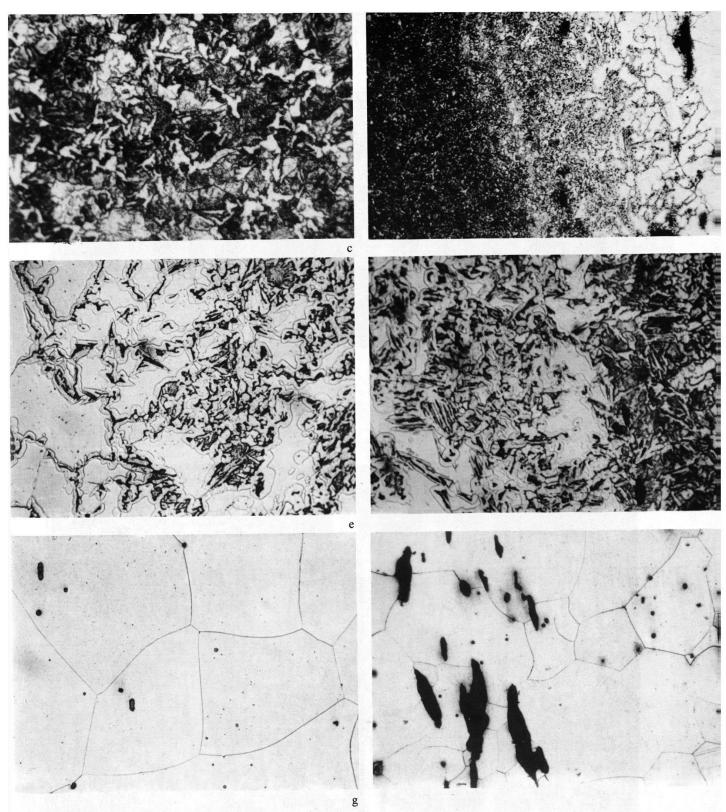
Abb.8 c) linke Deckschicht, Ferrit + Sorbit,  $V = 600 \times$ ;
