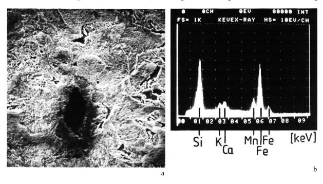
Abb. 15 Schmelzschlacke im Kern des Schwertes aus Augst (Inventarnr. 1961.4401): a) mikroskopische Aufnahme der Schlacke (REM), V = 2500 ×;
