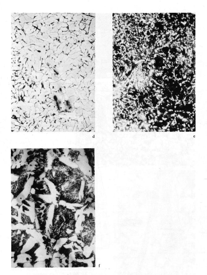
Abb. 4 d) mittlere Kernzone (niedriggekohlt), Ferrit + Perlit, V = 150 x;
