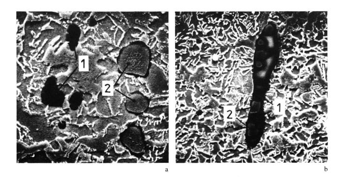
Abb. 21 Schmelzschlacken in der Deckschicht des Schwertes aus Vindonissa (Inventarnr. 1938):
