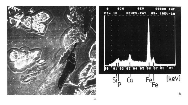
Abb. 23 Schlacken in der Schweissnahtstelle des Schwertes aus Vindonissa (Inventarnr. 1938):
