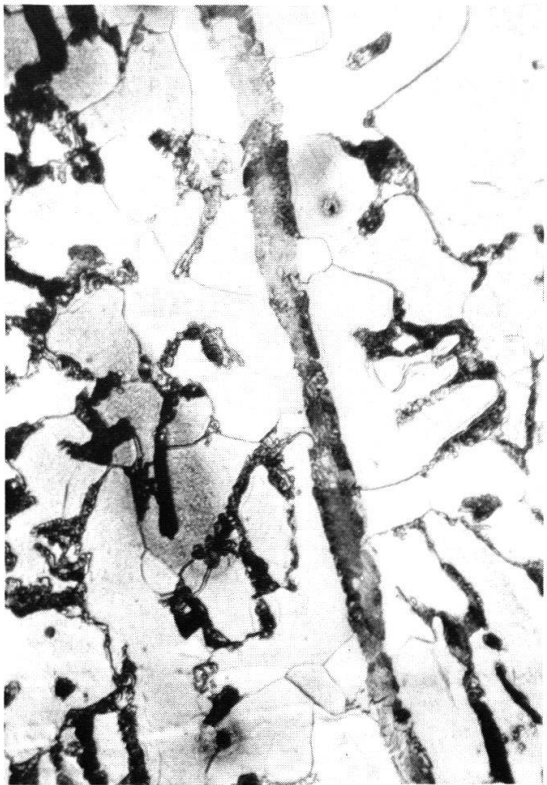
Abb. 4 Mikrostrukturen des Schwertes aus Augst (Inventarnr. 1961.4401) in der mittleren Klingenzone: a) Gesamtbild, V = 45 \times (Abb. 20 \times ); b) rechte Deckschicht, Ferrit + Perlit, V = 300 \times ; c) Schweissnahtstelle zwischen Kern und der rechten Deckschicht, Ferrit + Perlit, V = 600 \times ;
