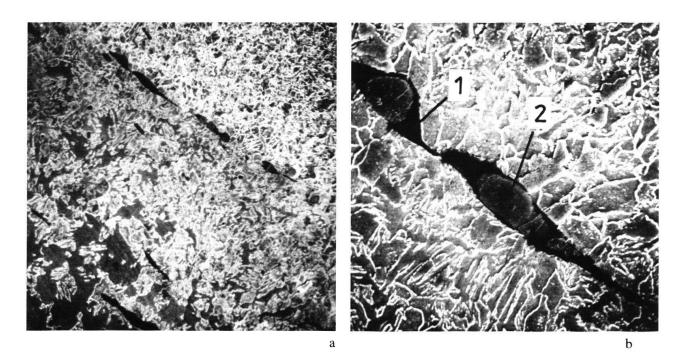
Abb. 22 Schlacken in der Schweissnahtstelle des Schwertes aus Vindonissa (Inventarnr. 1938):
