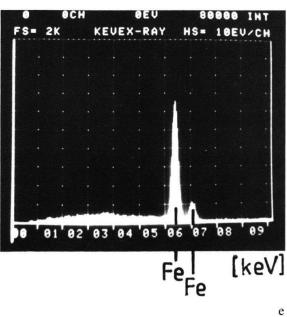
Abb. 24 d) energiedispersives Röntgenspektrum der Stelle 2 in Abb. 24b; e) energiedispersives Röntgenspektrum der Stelle 3 in Abb. 24b.
