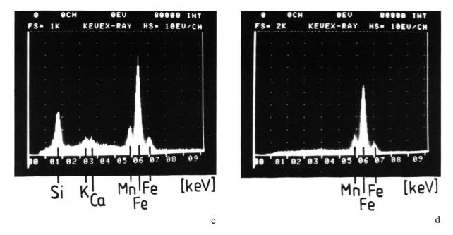
Abb. 21 c) energiedispersives Röntgenspektrum der Stelle 1 in Abb. 21a und 21b; d) energiedispersives Röntgenspektrum der Stelle 2 in Abb. 21a und 21b.
