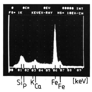
und Ca gebildet (*Abb. 23b*). Es sei hervorgehoben, dass die in der Schweissnaht eingelagerten Schlacken keinen Kalium-Gehalt aufweisen und trotz dem direkten Kontakt mit den Deckschichten auch kein Mangan enthalten.
