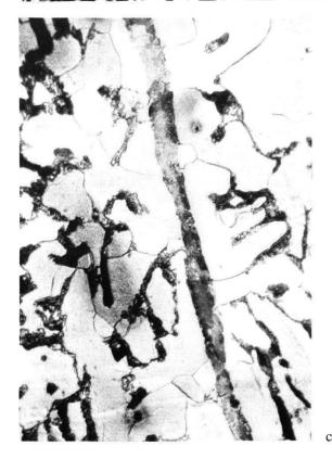
Abb. 4 Mikrostrukturen des Schwertes aus Augst (Inventarnr. 1961.4401) in der mittleren Klingenzone:
