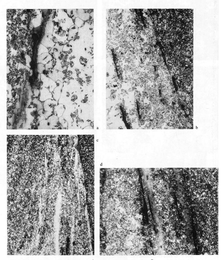
Abb. 9 Mikrostrukturen des Schwertes aus Vindonissa (Inventarnr. 1938) in der Übergangszone zwischen Kern und Schneide:
