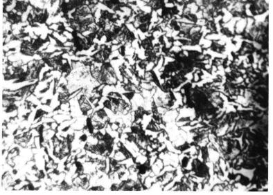
Abb. 8 Mikrostrukturen des Schwertes aus Vindonissa (Inventarnr. 1938) in der mittleren Klingenzone:
