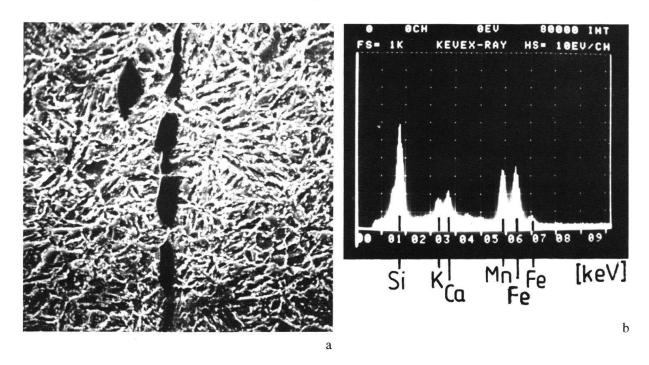
Abb. 20 Schmelzschlacken in der Deckschicht des Schwertes aus Vindonissa (Inventarnr. 1938): a) mikroskopische Aufnahme der Schlacken (REM), V = 1200 ×;
