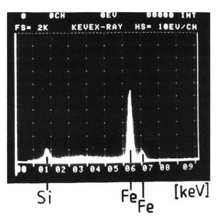
Abb. 17 Schlacken in der Schweissnahtstelle des Schwertes aus Augst (Inventarnr. 1961.4401):
