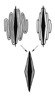
Abb. 27 Schematische Darstellung der vermutlichen Herstellungsarten des Schwertes aus Augst (Inventarnr. 1961.4401).
