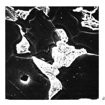
Abb. 5 Mikrostrukturen des Schwertes aus Augst (Inventarnr. 1961.4401) in der Schneidezone:
