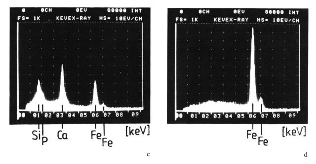
Abb. 22 c) energiedispersives Röntgenspektrum der Stelle 1 (dunkler Schlackenhintergrund) in Abb. 22b; d) energiedispersives Röntgenspektrum der Stelle 2 (helles Schlackenteilchen) in Abb. 22b.
