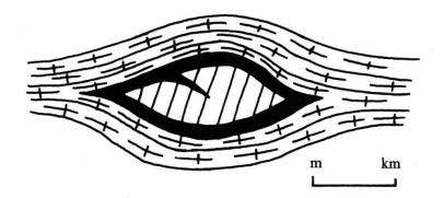
Abb. 14 Schematischer Aufbau einer Lavez-Lagerstätte. (Grösse der Linsen variiert zwischen wenigen Metern und mehreren Kilometern).
