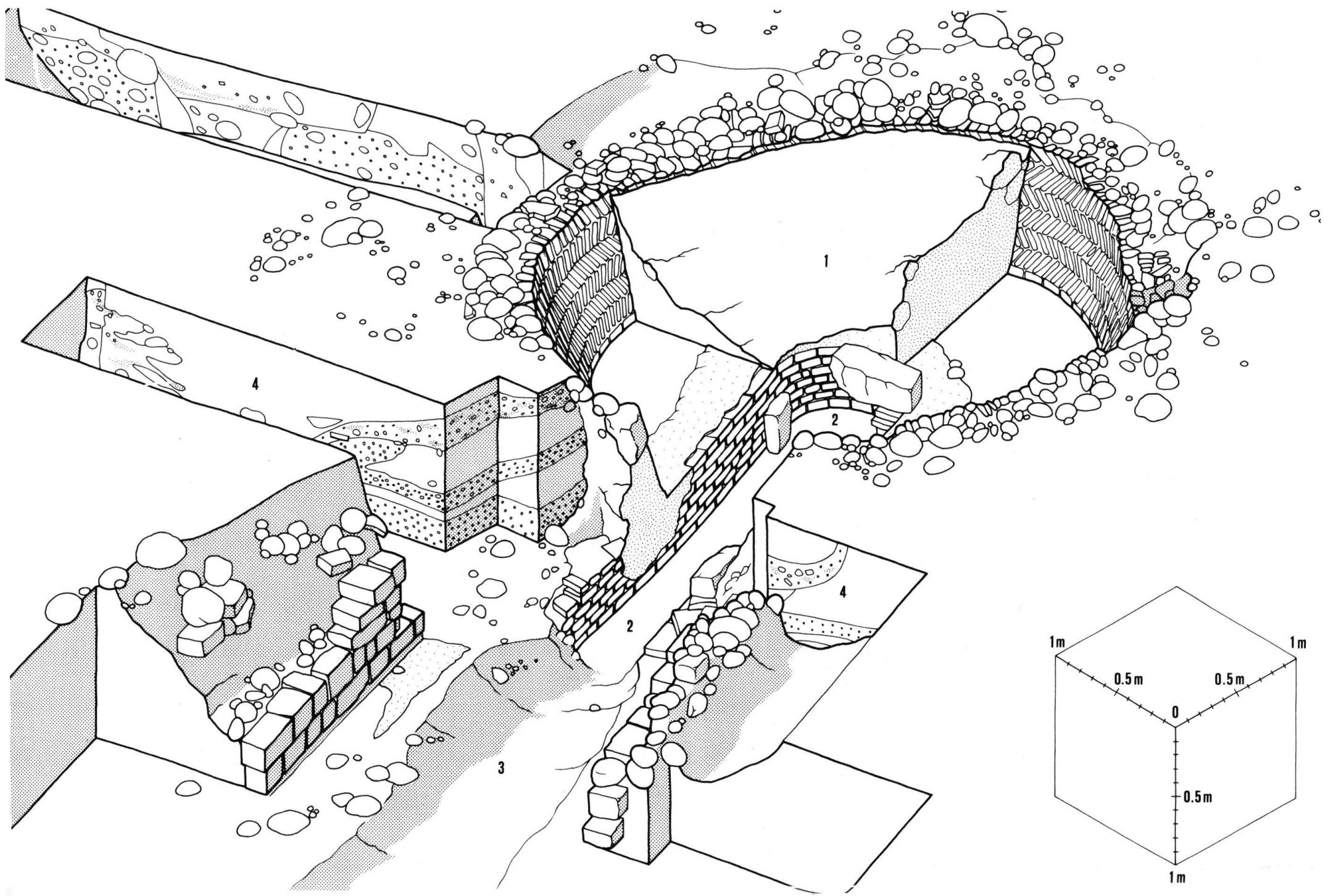
Ofenkammer und Zugkanal wiesen am Ziegelmauerwerk und auf den Kiesböden dicke Kalkkrusten auf. Auch in der Küche und auf der zu ihr hinunterführenden Rampe breitete sich ein Kalkbelag aus, was ein klarer Hinweis darauf ist, dass nach dem Brand der Ofen zur Küche hin (und nicht von oben) entleert wurde.
