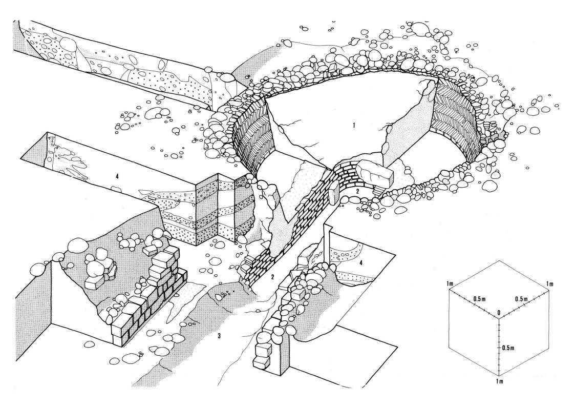
Ofenkammer und Zugkanal wiesen am Ziegelmauerwerk und auf den Kiesböden dicke Kalkkrusten auf. Auch in der Küche und auf der zu ihr hinunterführenden Rampe breitete sich ein Kalkbelag aus, was ein klarer Hinweis darauf ist, dass nach dem Brand der Ofen zur Küche hin (und nicht von oben) entleert wurde.
