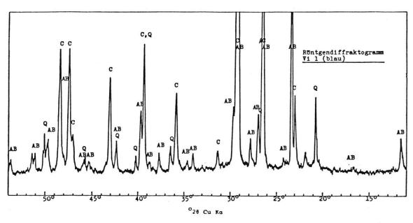
Figur 2 Röntgendiffraktogramm einer blauen Oberfläche; AB = Ägyptisch Blau, C = Calcit, Q = Quarz.
