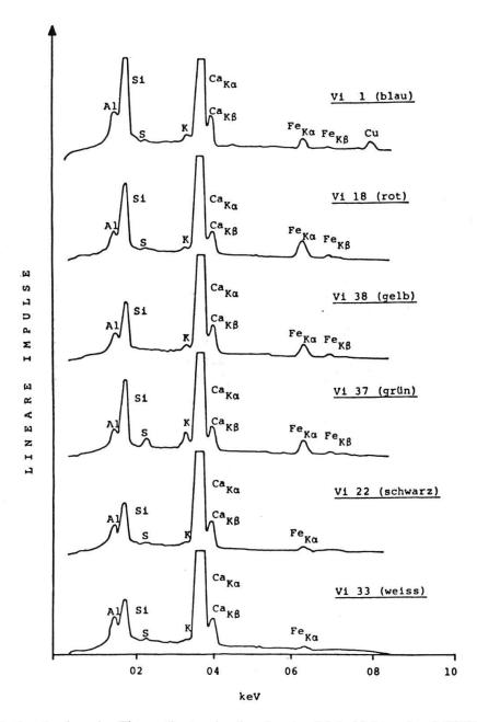
Figur 1 Qualitative Analyse des Elementbestandes der obersten Malschichten durch EDX.
