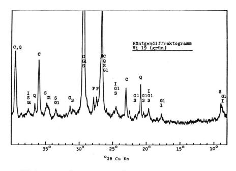
Figur 8 Röntgendiffraktogramm einer grünen Oberfläche; Gl = Glaukonit, S = Seladonit, restliche Abkürzungen wie bei den vorgehenden Figuren.
