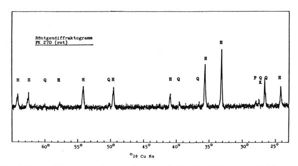
Figur 4 Röntgendiffraktogramm eines gemahlenen roten Farbknollens; Abkürzungen wie bei den vorgehenden Figuren.
