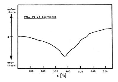
Figur 12 DTA-Kurve einer schwarzen Probe.
