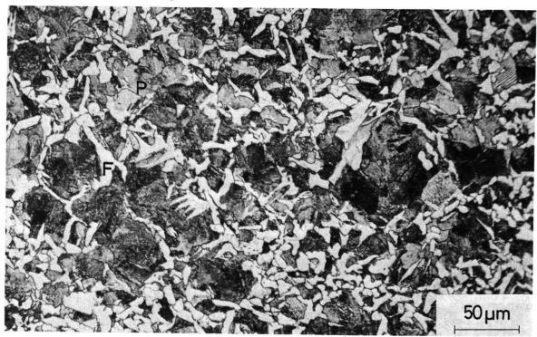
Bild 8 Querschliff S. 2 an Pilumspitze 18. Stahl bei Spitzenkante mit Widmannstätten-Gefüge aus Ferrit (F) und feinlamellarem Perlit (P).
