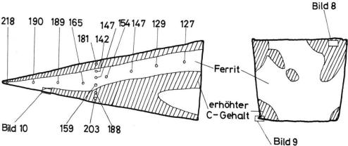
Bild 7 Längsschnitt S. 1 und Querschliff S. 2 durch Pilumspitze (Objekt 18). Ca. 7fach vergrössert. Weiss: ferritische Schmiedeeisen-Bereiche. Schraffiert: Gebiete mit erhöhtem C-Gehalt (Stahl). Angabe der Mikrohärtewerte und der Lage der Schliffbilder 8–10.
