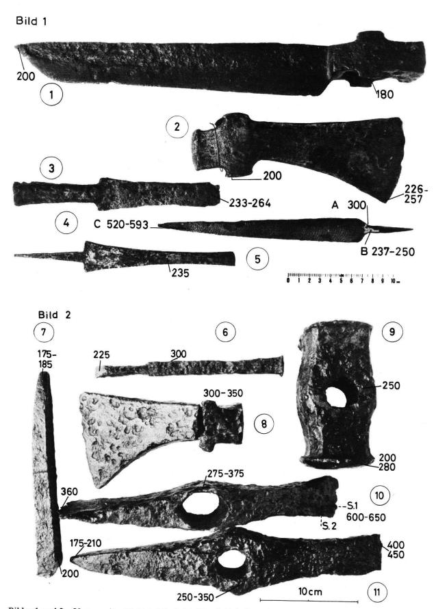
Bilder 1 und 2 Untersuchte Objekte Nr. 1–11 (Vergl. Tabelle 1, Seite 33). Die angegebenen Ziffern sind Härtewerte (Vickers-Makrohärte HV). S. 1, S. 2 . . . bezeichnen die senkrecht zur Bildfläche stehenden Schliffe.
