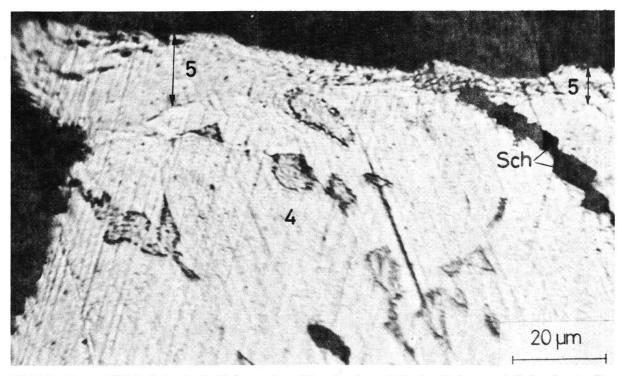
Bild 15 Querschliff S. 1 durch die Bohrerspitze. Oben konkave Seite des Bohrers mit Bohrerkante. Der Gefügebereich 4 enthält eine zerhackte Schlackenzeile (Sch). Gegen Bohrerinnenseite die kaltverformte (geschliffene) Zone 5 mit deutlicher Bartbildung an der Kante (links), die beim Schleifen des Bohrers entstanden ist.
