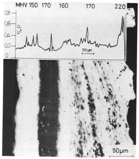
Bild 17 Sägeblatt-Querschnitt.
