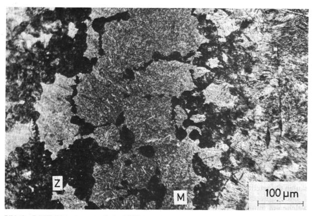
Bild 19 Schliffbild der härtesten Stelle (MHV 800 auf Bild 18) des Pickelschneiden-Längsschliffes. Martensit (M) und Zwischenstufengefüge (Z).
