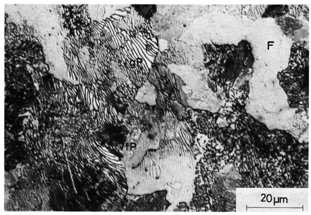
Bild 5 Ahle, Querschnitt S. 1, Zone A. Stahl aus Ferrit (F) und Perlit. Groblamellarer (gP) und feinlamellarer Perlit (fP). Lage des Bildes siehe Bild 4a.
