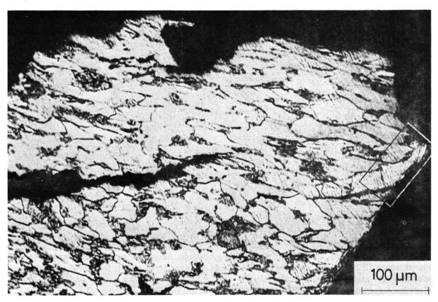
Bild 14 Gefügebereich 4 auf Schliff S. 1. C-armer, ferritisch-perlitischer Stahl. Verformungsgefüge (warm verformt). Rechts eingezeichnet das Bild 15.
