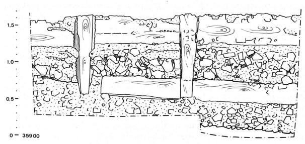
Abb. 3. Windisch-Scheuerhof 1968. Nördliche Fundamentmauer des Apsidenbaus mit Abdrücken der Bretterverschalung. Zeichnung O. Lüdin.
