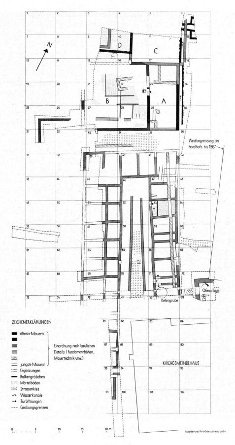
Abb. 3. Windisch-Friedhoferweiterung 1967. Grundrißplan mit Angabe der Bauperioden und Feldereinteilung. Maßstab 1:500. Zeichnung O. Lüdin und D. Gisler.
