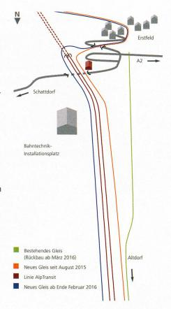
Im Frühling 2016 bauen die SBB die Gleisanlagen und Fahrleitungen der alten Stammlinie zurück.
