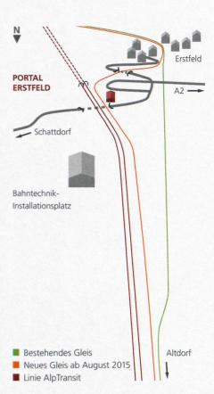
die Inbetriebsetzung auf Hochtouren. Fast unbeachtet arbeiten die Rohbauer, Mitarbeiter der SBB und der Unternehmer Bahntechnik intensiv an der Inbetriebnahme des neuen Gleises Altdorf–Erstfeld. Während der Betrieb auf der SBB-Stammlinie weiterläuft, wird nach und nach der Anschluss ans Portal des Gotthard-Basistunnels realisiert.
