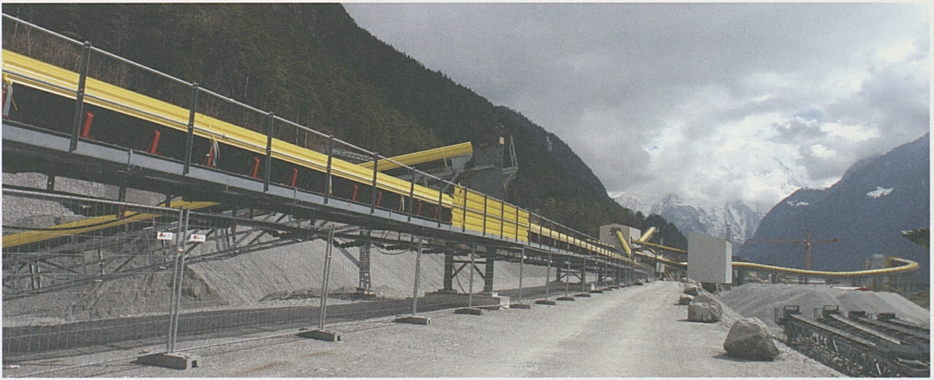
Von der Siebstation (Hintergrund) geht das Ausbruchmaterial per Förderband in die Zwischenlager.
