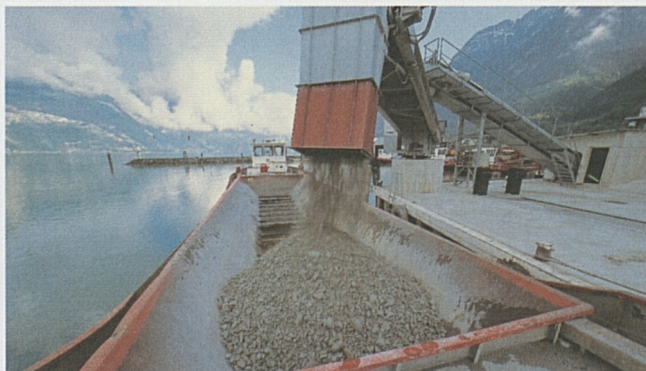
Bei Vollbetrieb werden täglich bis 4000 Tonnen Material auf die Nauen verladen.
