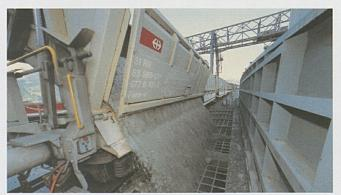
Die Umschlagleistung der Entladegosse beträgt 800 Tonnen pro Stunde.
