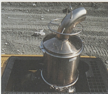
Mit dem Einbau von Dieselpartikelfiltern (siehe Bild) werden die lungenschädigenden Feinstpartikel um über 90% reduziert bzw. zurückgehalten.
