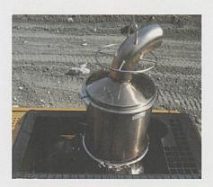
Mit dem Einbau von Dieselrussfiltern (siehe Bild) werden die lungenschädigenden Feinstpartikel um über 90% reduziert bzw. zurückbehalten.
