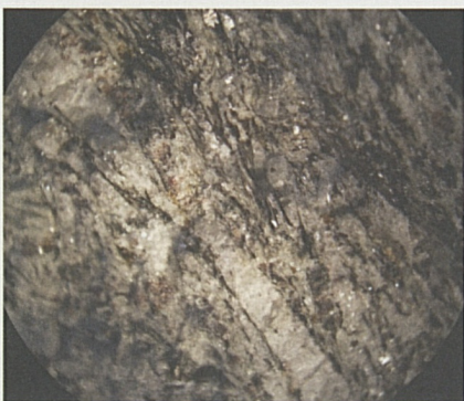
Carota: gneis ricco di mica. Galleria a binario unico per usi logistici del cantiere.
