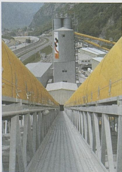
Foto in alto: nastri trasportatori e impianto di irrigazione per l'abbattimento delle polveri a Bodio-Pollegio.
