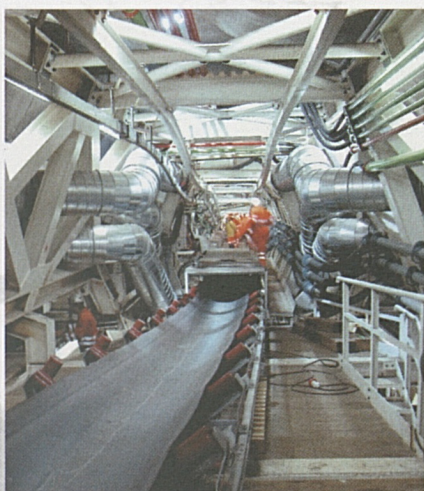
Foto sopra: il nastro trasportatore sulla fresatrice (tubo ovest).
