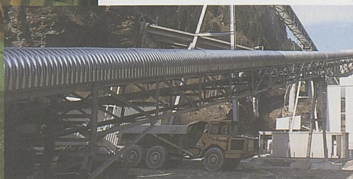
*Sopra: Il nastro trasportatore del materiale di scavo al deposito della Cavienza.*
