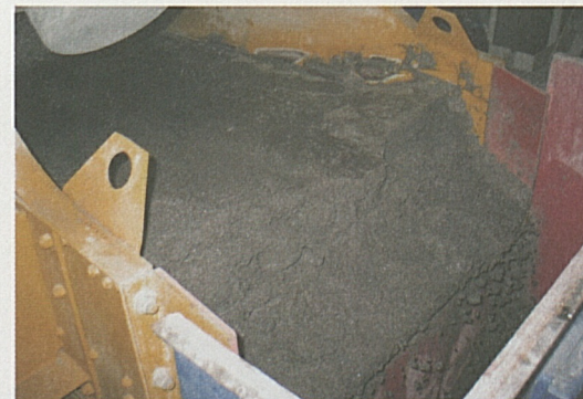
Materialfluss innerhalb der Flotationsmaschine.
