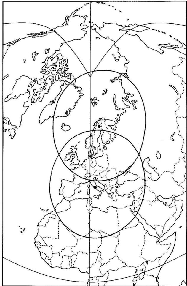
Fig. 1 : Empfangsbereich der Bodenstationen Kiruna (Schweden) und Fucino (Italien) für LANDSAT-Daten.
