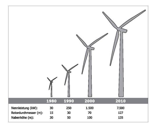
Abb. 2: Leistungssteigerung von Windenergieanlagen, 1980-2010
