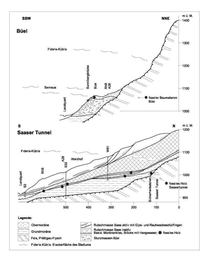
Fig. 3: Geologische Querprofile: Büel (784'150/195'750), Saaser Tunnel (781'700/197'800) Geological cross-section: Büel (784'150/195'750), Saaser Tunnel (781'700/197'800) Coupes géologiques: Büel (784'150/195'750), tunnel de Saas (781'700/197'800) Graphik: Büro Dr. Max Kobel, Sargans
