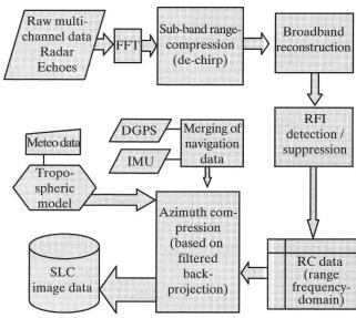
Abb. 3: Die SAR-Datenverarbeitungskette für die Generierung von Ultra-Breitband SAR Bildern Processing chain for generation of low-frequency ultra-wideband images
