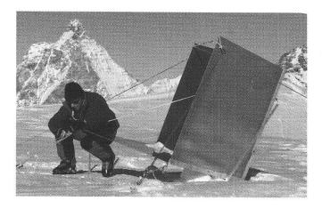
Abb. 2: Beispiel eines 1.25 m Reflektors vor dem Matterhorn
