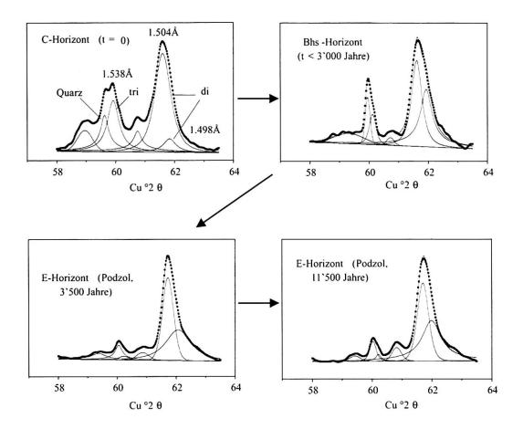
Abb. 8: Analyse der d(060) Region (Tonfraktion) vom Ausgangsmaterial (C-Horizont) bis hin zum E-Horizont des 11'500 Jahre alten Podsols; di = Peaks für dioktaedrische Mineralien, tri = Peak für trioktaedrische Mineralien
