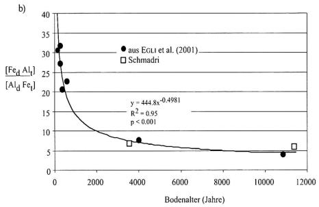
Abb. 2: Vergleich des a)  $Al_d$  /  $Fe_d$  Verhältnisses im B-Horizont und des b) mittleren  $[Al_tFe_d]$  /  $[Al_dFe_t]$  Verhältnisses im A, E und B Horizont (d = dithionit-extrahierbare Fraktion, t = Totalgehalt) unterschiedlich entwickelter Böden mit der Zeit. Die Daten wurden mit Ergebnissen aus ähnlichen Untersuchungsgebieten (bezüglich Geologie, Klima und Topographie) ergänzt und zwar für a) mit Egli et al. (2001) und Fitze (1982) und b) mit Egli et al. (2001).
