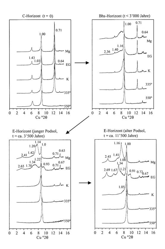
Abb. 7: Zeitliche Entwicklung der Mineralien in der Tonfraktion. Die Schichtabstände sind in nm angegeben. Mg = Sättigung mit Mg, EG = Bedampfung mit Ethylen Glykol, K = Sättigung mit K, 335° = Erhitzen bei 335° C, 550° = Erhitzen bei 550° C
