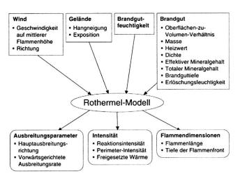
Abb.2 Eingangsdaten und Resultate des Rothermel-Modells.
