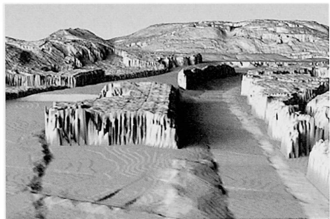
Abb. 2 Links: schattiertes DGM; rechts: DOM mit angehobenen und modulierten Waldpartien.
