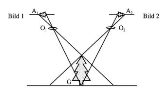
$A_1$ ,  $A_2$  = radial verzerrte Abbilder G = Geländesituation  $O_1$ ,  $O_2$  = Projektionszentren
