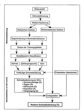
Abb.3 Schneeklassifikationsschema für optische Sensoren.
