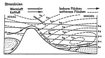
Abb. 5 Das zyklonale Hauptstadium einer Südföhnlage. Die Föhnströmung vermag bis in die Täler hinunter vorzudringen. Diese Entwicklung wird ermöglicht durch den großen Druckgradienten und das gut entwickelte Solenoidfeld, die der Föhnströmung auf der Leeseite die notwendige Absinkbeschleunigung und Energie verschaffen.
