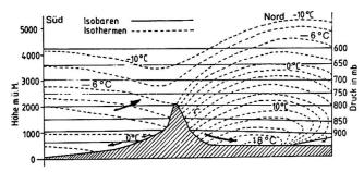
Abb. 4 Das Druck-, Strömungs- und Temperaturfeld im Höhepunkt der Föhnlage vom 8. November 1982 um 6 Uhr.
