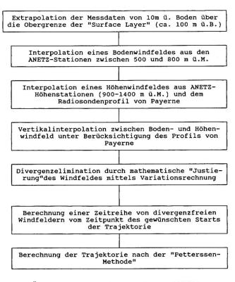
Fig. 2 Übersicht über die Einzelschritte von WITRA
