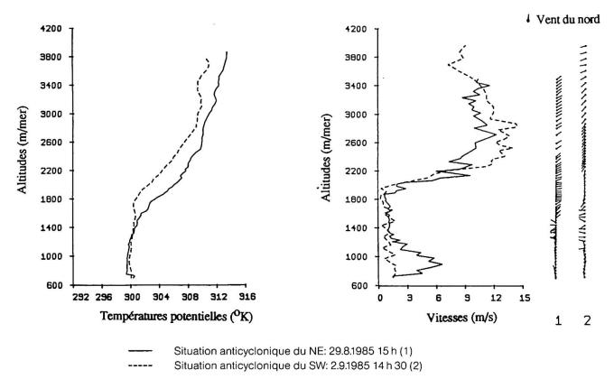
Figure 3b Profils des températures potentielles (à gauche) et des vents (à droite) mesurés en Gruyère (Broc) l'après-midi de deux situations anticycloniques estivales typiques.
