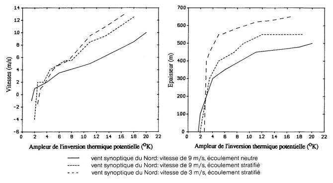
Figure 5 Modèle physique: évolution des vitesses maximales (à gauche) et de l'épaisseur (à droite) des brises de montagne en Gruyère en fonction de l'ampleur du refroidissement nocturne.
