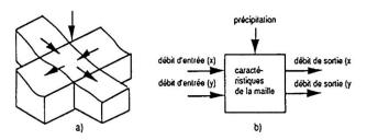
Fig.1: Représentation physique des écoulements sur une maille et schématisation du traitement (d'après Abednego, 1989).
