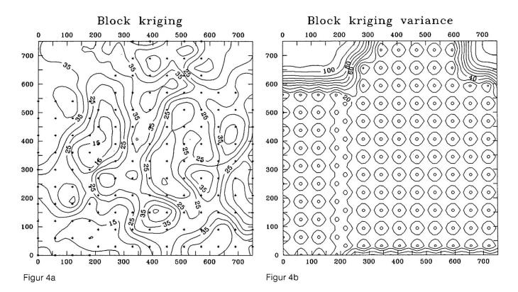
4a) Kriging-Interpolation des prozentualen Sandanteils auf einen 30-m-Raster und Isolinieninterpolation mit Hilfe von Spline-Glättung. Die originalen Meßstandorte sind durch einen Stern gekennzeichnet. 4b) Fehleroberfläche zu Fig. 4a. Die Schätzfehler sind klein in der Nähe der Datenpunkte (<10%²), wachsen aber in Gebieten ohne Datenwerte bis über 100%² an.
