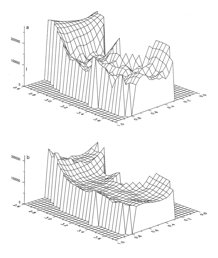
Figur 5 5a) Fehleroberfläche der Interpolation des Zinkanteils in der Flußebene, berechnet durch einfaches Kriging. Im Bereich geringer Stichprobendichten übersteigen die Fehler 300 000 mg/kg². 5b) Fehleroberfläche des Zinkanteils in der Flußebene, berechnet mit Co-Kriging mit zusätzlichen Höhendaten. Der durchschnittliche Fehler wird um 50 000 mg/kg² reduziert, der maximale Fehler beträgt noch rund 200 000 mg/kg².
