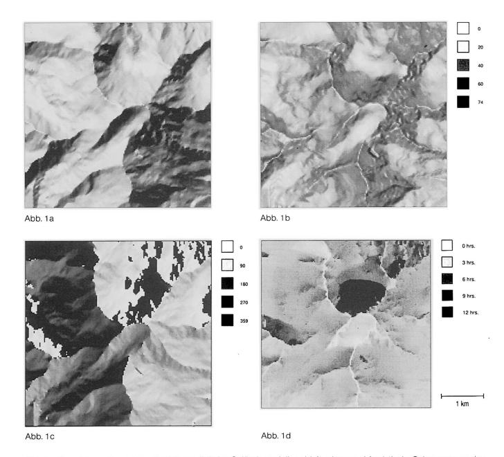
Abb. 1 Beispiele von Produkten, die sich aus digitalen Geländemodellen ableiten lassen. a) Analytische Schummerung des Geländemodells. b) Hangneigung in Grad. c) Exposition in Grad. d) Beschattungsdauer in Stunden für den 21. März in der Zeit zwischen 6.00 und 18.00 (unter Mithilfe von V. Antunes, FH Karlsruhe). Ausschnitt 4 × 4 km im Raum Fletschhorn (VS). Gitterförmiges DGM mit 25 m Maschenweite.
