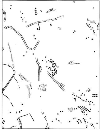
Abb.4 Das Differenzbild aus dem Negativ von Abb.2, abmaskiert mit dem Positiv von Abb.1, zeigt alle zwischen 1976 und 1982 neu hinzugekommenen Elemente.
