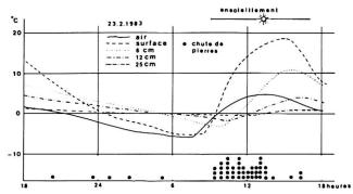
Figure 9B Variations de la température de la roche et des chutes de pierres lors de faibles gelées nocturnes suivies d'intense réchauffement.
