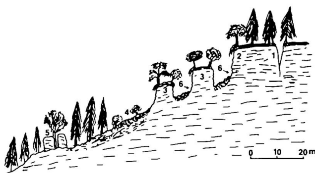
Figure 1 Le Château Cugny: coupe schématisant des lieux. 1. échancrure profonde, 2. paroi principale avec racines d'arbres pendant dans le vide, 3. «châteaux», 4. éboulis, 5. gros blocs éboulés, 6. localisation des mesures.
