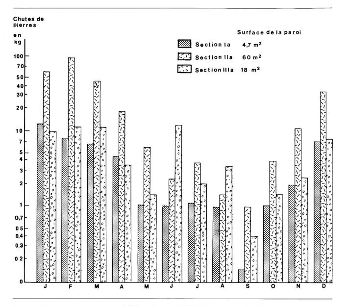
Figure 7 Régime des chutes de pierres à Château Cugny (sept. 81-juill. 83), moyenne arithmétique des deux ans.
