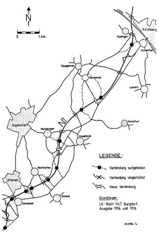
Abb. 4 Unterbrüche im lokalen Wegnetz durch den Bau der «N1» im Abschnitt Schönbühl-Kirchberg.
