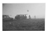
Photo 2 Einsatz des Ballonsondiersystems zur Erfassung des vertikalen Temperaturverlaufes
