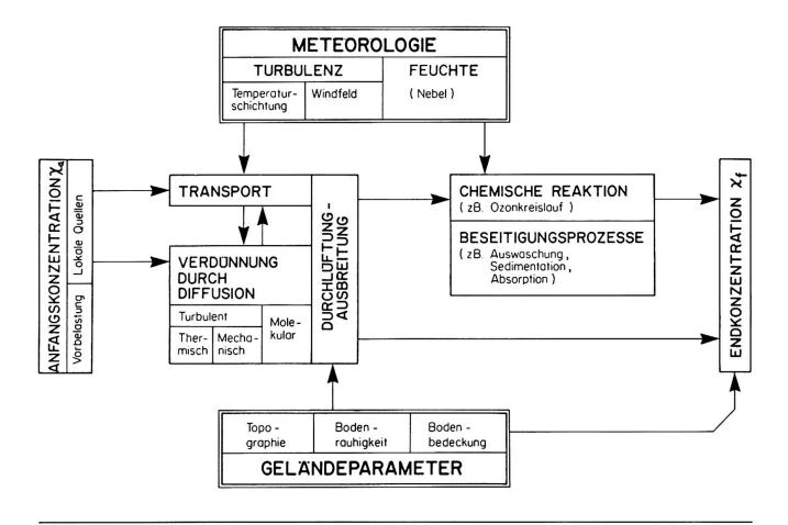
Fig. 1 Vereinfachtes Wirkungsgefüge zur Ausbreitung von Luftfremdstoffen
