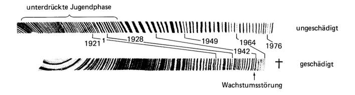
Abb. 2 Okulare Datierung mit Hilfe von Weiserjahren am Beispiel zweier radiographierter Bohrkerne von Waldföhren (*Pinus silvestris* L.) aus dem Untersuchungsgebiet bei Saxon. (1) — ohne Binokular nicht erkennbare Weiserjahre.
