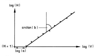
Bild 3: Bestimmung der Beiwerte a und b auf doppelt-logarithmischem Papier
