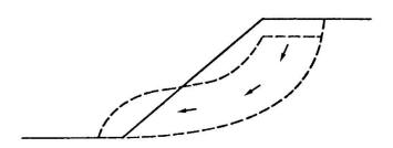
Bild 2 Schematische Darstellung einer Sackung.
