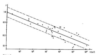
Bild 5 Korrelation zwischen Reibungskoeffizient f und Bergsturzvolumen V (nach Scheidegger).
