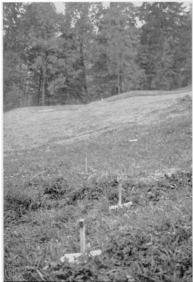
Bild 1 Nachkontrolle einer Vermarkung nach einiger Zeit: Die Pfähle waren ursprünglich in einer Geraden.
