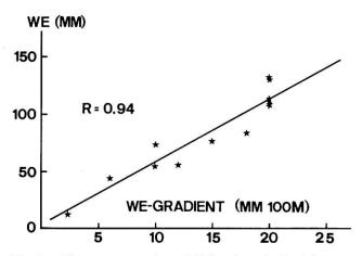
Fig. 5: Wasserwertgradient (WE-Gradient) in Funktion des regionalen Wasserwertes im Wolf River Basin.
