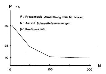
Fig. 2: Prozentuale Abweichung der Schneehöhen vom Mittelwert bei gegebener Anzahl Messungen. (μ = 95%)
