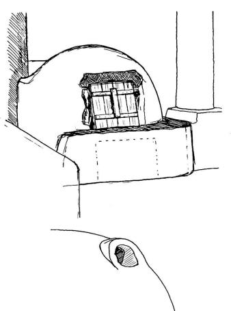
Fig. 1: Backofen im Ortsteil Ficogrande. Sorgfältig renoviert, seit Jahren außer Gebrauch. Gestrichelt: zugemauerter Raum für Brennholz. Auf der Rückseite: Rauchabzug, der beim Backen verschlossen wird.
