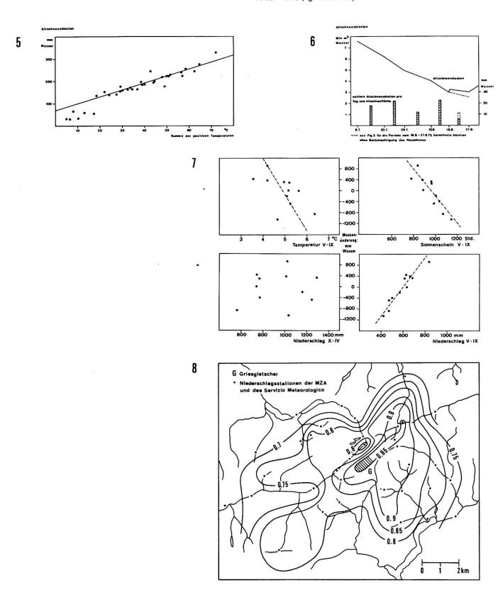
Wird nun mit Hilfe dieser Regressionsgleichung die Altschneeablation der Periode 18. 8.–27. 8. 1972 berechnet, erhält man einen Volumenverlust von 425 759 m³ Wasser. Dem steht ein tatsächlicher Verlust von nur 275 837 m³ Wasser gegenüber (Fig. 6).
