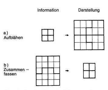
Figur 4. Behelfsmäßiges Aufblähen bzw. Zusammenfassen zur unverzerrten Wiedergabe von quadratischen Einheitsflächen mit dem Schnelldrucker
