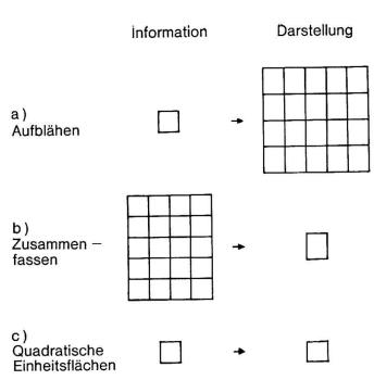
Figur 3. Möglichkeiten zur unverzerrten Wiedergabe von quadratischen Einheitsflächen mit dem Schnelldrucker
