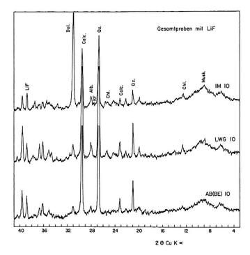
Figur 1. Diffraktometerdiagramme einiger Gesamtproben. Unorientierte Präparate Abkürzungen: LiF Lithiumfluorid, Dol. Dolomit, Calc.Calcit, Alb.Albit, KF Kalifeldspat, Qz.Quarz, Chl. Chlorit, Musk. Muskowit
