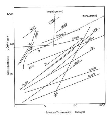
Figur 9. Beziehungen zwischen Schwebstoffkonzentration, Cs und Durchfluβmenge Q. Cs = a · Qb Die schematischen Linien sind aus den Punktwolken der einzelnen Stationen ermittelt worden. Einige Punktwolken sind in den Fig. 5, 6 und 7 dargestellt. Die für die Linien verwendeten Abkürzungen sind in der Tabelle 1 erläutert.
