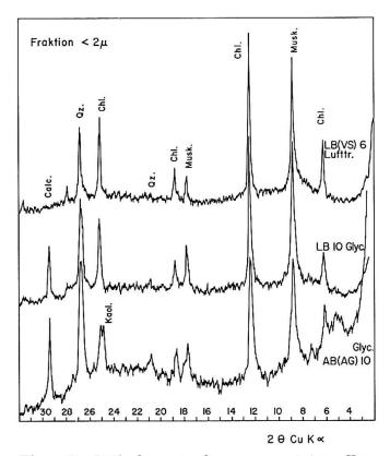
Figur 2. Diffraktometerdiagramme einiger Tonproben (Fraktion  $\langle 2\mu \rangle$ ). Texturaufnahmen bei verschiedenen Aufnahmebedingungen Abkürzungen: Calc. Calcit, Qz. Quarz, Kaol. Kaolinit, Ch. Chlorit, Musk. Muskowit, Lufttr. Lufttrocken, Glyc. mit Äthylenglycol
