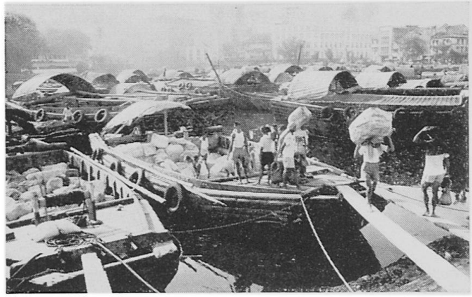
Abbildung 3. Traditioneller Umlad von Waren im Singapore River, hier Rubber Sheet-Ballen von 125 kg Gewicht, mit Hilfe von Kulis oder Auto-kranen. Diese hölzernen Leichter bedienen die in den «Outer Roads» ankernden Frachtschiffe. (Photo RS, April 1971)
