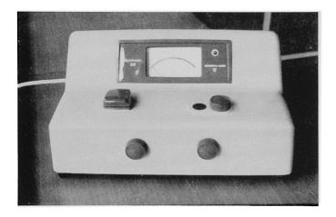
Abbildung 2. Kolorimeter Spectronic 20
