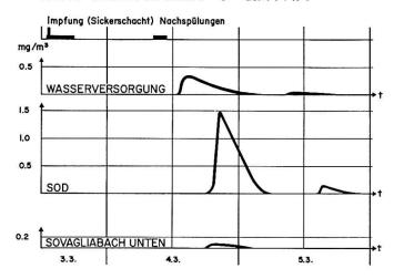
Aus den verwendeten Daten geht hervor, daß vermutlich etwa die Hälfte des Trinkwassers aus der Pumpstation der Wasserversorgung Rovio infiltriertes Sovagliawasser ist.
