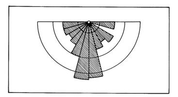
Figur 3. Das Sammelsitugramm der eingemessenen Wanderblöcke entspricht dem «Solifluktionssitugramm» in Zwischenstreifen
