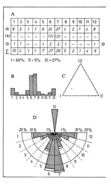
Figur 1. Verschiedene Darstellungsmethoden fü situmetrische Ergebnisse. A: Tabellarisches Meß protokoll, B: Säulendiagramm, C: Dreieckkoordina ten, D: Situgramm. Das Beispiel entstammt einen fossilen Steinstreifen im Ruckfeld AG
