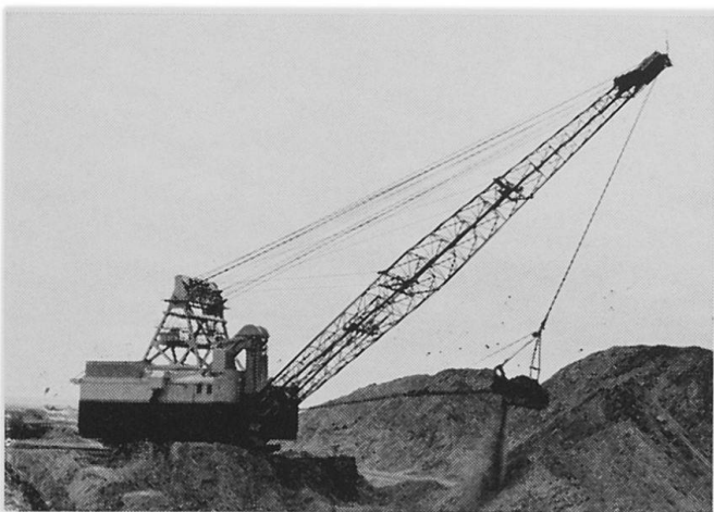
Abbildung 5. Tagbau bei Oued-Zem (Lager von Sidi Daoui). Der Riesenbagger «Marion 7900», der hier die Deckschichten entfernt, wiegt 1817 t. Kabine und Aufbau sind zusammen 23 m hoch. Die Schaufel faßt 35—40 m 3 Erdreich (rund 100 t). Photo Verfasser
