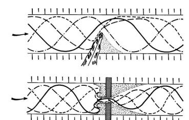
Störung migrierender Mäanderflüsse (stark schematisiert). Oben: Wirkung einer einseitigen Ablenkung. Unten: Wirkung einer starken lokalen Einschnürung (Brücke).
