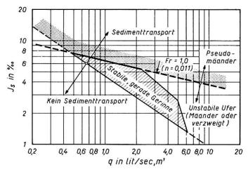
Fig. 25 Sohlengefälle  $J_s$  in Abhängigkeit der Abflußmassermenge (pro Laufmeter Gerinnebreite). Dargestellt sind die verschiedenen Bereiche der Gerinnebildung für ein Geschiebe von  $d_m = 0,67$  mm eines Laboratoriumsversuches (stark schematisiert) (61). (Fr = Froud'sche Zahl, n = Rauhigkeitskoeffizient nach Manning).
