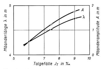
Fig. 15 Abhängigkeit der Wellenlänge  $\lambda$  und der Amplitude A vom Talgefälle  $J_T$  bei konstantem Q aus Modellversuchen (21).
