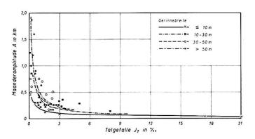
Fig. 16 Abhängigkeit der Amplitude A vom Gefälle J<sub>T</sub> unter Berücksichtigung der Flußbreite (29)\*.
