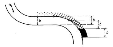
Fig. 5 Erosionsbereich an mittelstark gewundenem Fluß (47).
