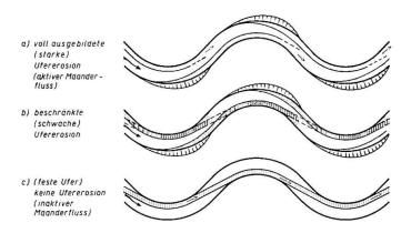
Fig. 17 Wegbahnen des Geschiebes in Mäanderflüssen mit voll ausgebildeter, mit beschränkter und ohne Ufererosion nach Modellversuchen (21) (stark schematisiert).
