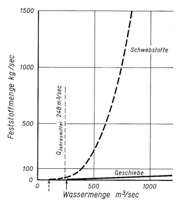
Fig. 3 Rhein bei Brügg/St. Gallen: Geschiebeführung Gg und Schwebstofführung Gs in Abhängigkeit der Wasserführung Q, aufgenommen in den Jahren 1936/39 durch die Rheinbauleitung.
