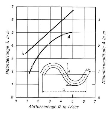
Fig. 14 Abhängigkeit der Amplitude A und der Wellenlänge  $\lambda$  von der Abflußwassermenge Q aus Modellversuchen (21)<sup>18</sup>.
